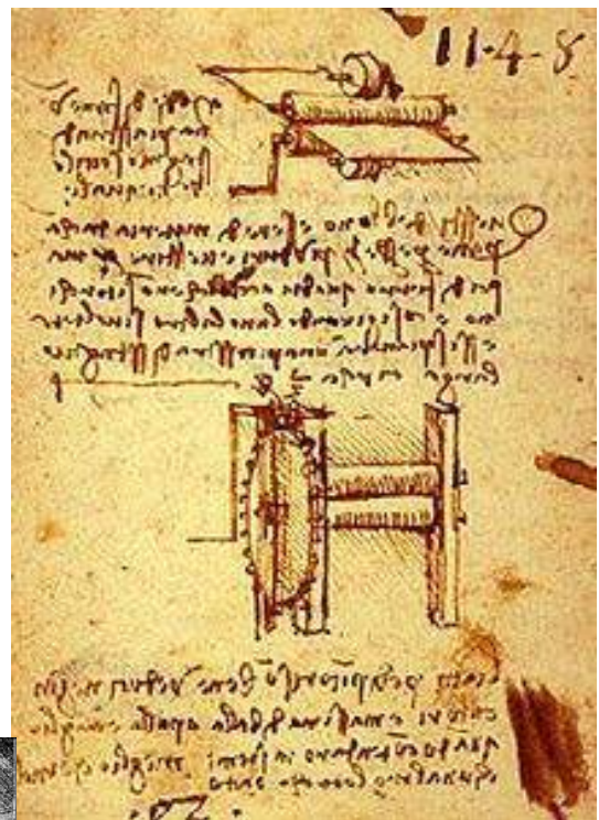
Il laminatoio in una illustrazione di Leonardo da Vinci.
