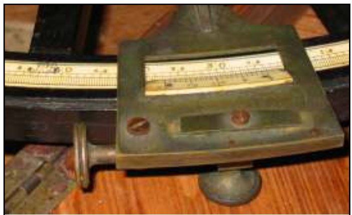
Un ottante con nonio e vite micrometrica.
